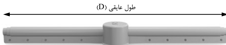
شکل ۱: شمای کلی کاور مقره پلیمری
